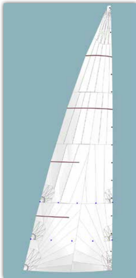
Radiella skärningar. Det innebär att fiberriktningarna strålar ut från seglets horn.
