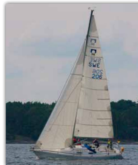
Omega 36 med storsegel och genua i radialskurna cruisinglaminat av polyester.
