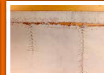
Dacron med crosscut. Uppskattningsvis tillverkad för 15 år sedan. Vid akterliket finns en rejäl reva som ska repareras med nya mindre paneler.
